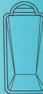
PAROS L 10,50 m x l 4,20 m Petit bain 1,30 m Grand bain 2,20 m
