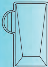
PANAMA L 8,20 m x l 4,20/5,20 m Petit bain 1,10 m Grand bain 2 m
