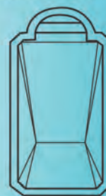
TINOS L 7,80 m x l 3,80 m Petit bain 1,00 m Grand bain 1,75 m
